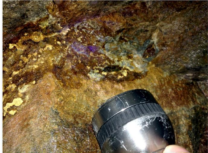
Foto 7: Lente uranizzata con minerali secondari di uranio (incrostazioni gialle), più spesso da accumulo idrotermale, all'interno della galleria d'assaggio.
